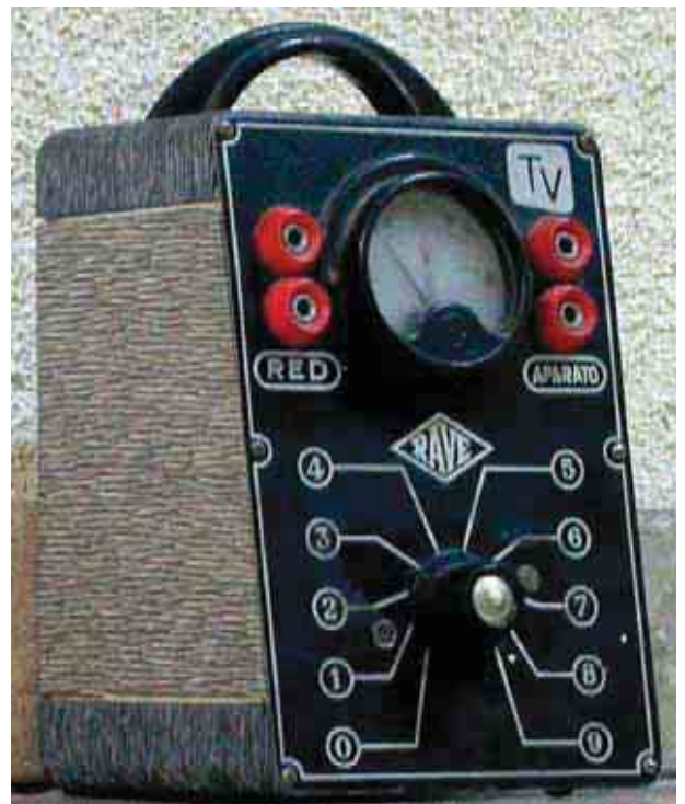
▲ Transformador de 125-220 voltios, 12 x 17 x 12 cm. 1960-1970.
