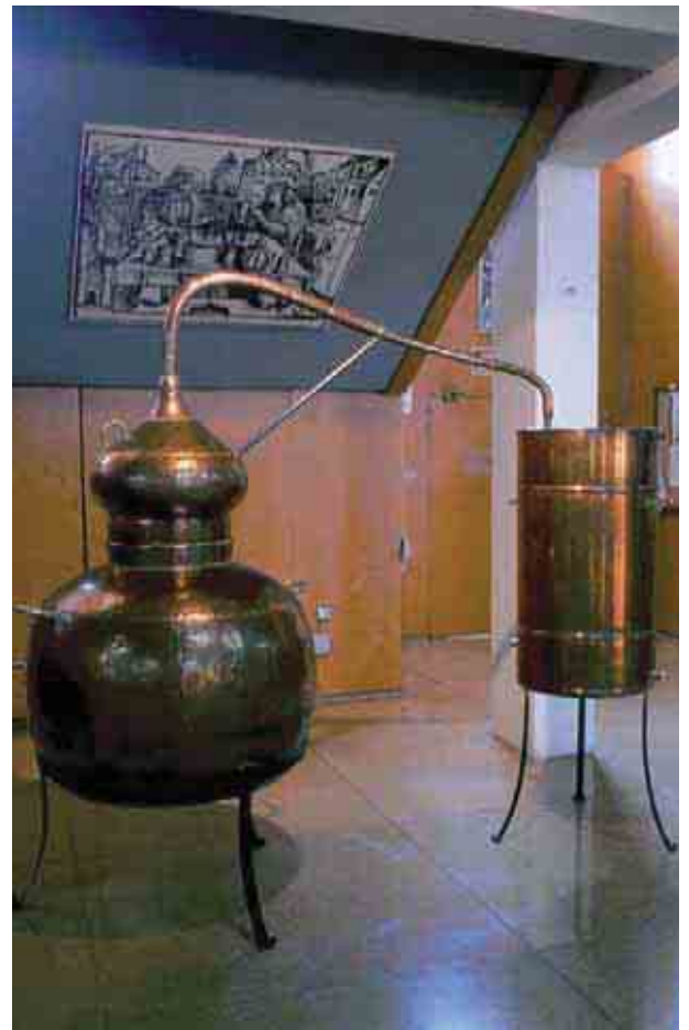
▲ Alambique de cobre de dos piezas expuesto en la Facultad de Farmacia, 102 x 171 cm y 159 x 55 cm de diámetro.
